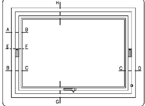
BENENNUNG: SCHWINGFENSTER MIT BESCHLAG UNITAS 5 BO, 7 BO UND 10 MIT ZENTRALVER-SCHLUSS GU-FERCO 330
